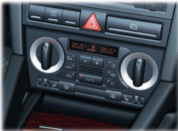
Das Steuergerät für Climatronic J255 ist den Varianten mit und ohne Sitzheizung sowie ein 1DIN- oder 2DIN-Schacht hohes Radio möglich.
