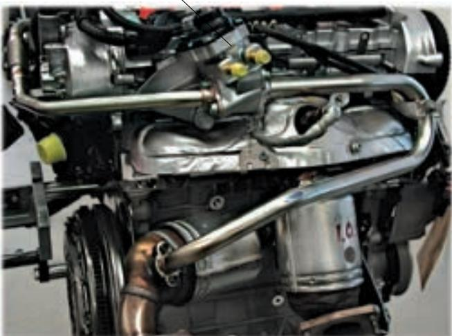
Das Abgasrückführungsventil kommt als Drehklappenventil wie im A4 zum Einsatz.
