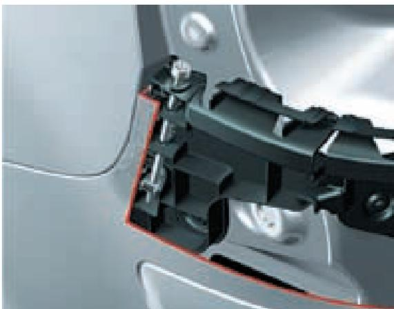
Die Nullfuge zwischen Stoßfänger und Seitenteil wird nicht mit einer Schraub-, sondern durch eine Clipverbindung umgesetzt.
